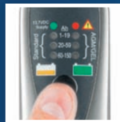
Valitse oikea asento, akkukoko (Ah) ja akkuteknologia (AGM/GEL tai vakioakku). Vaihtoehtoisesti 13,7 V Supply.
